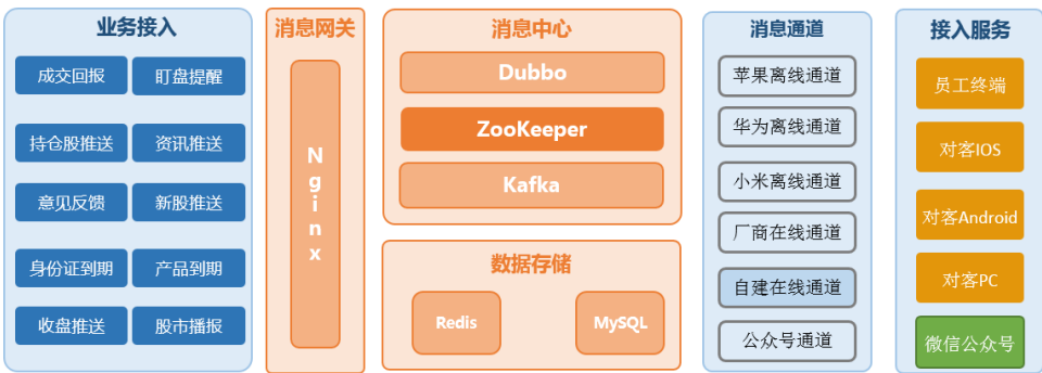
图 7 消息中心架构图
